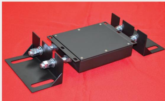
この装置は、ストーブ脚部を固定するのではなく、家の床面とストーブ本体を固定して地震発生時に一番負担がかかると言われているストーブ脚部に負担を掛けないようにし、地震時のストーブ移動による家の破損やストーブ脚部の破損によるストーブ転倒を防ぎます。
